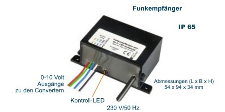
Der Funkdimmer 0-10 Volt (4-Kanal) kann bis zu vier Ausgangskanäle unterschiedlich dimmen oder schalten.
